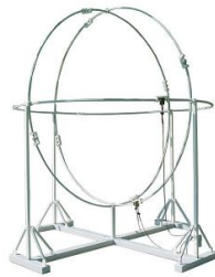
Figure I.8 – Antenne cadre de type Van Veen (Diamètre : quelques dizaine de centimètre à quelques mètre, Bande de fréquence : 9 kHz - 30 MHz)
