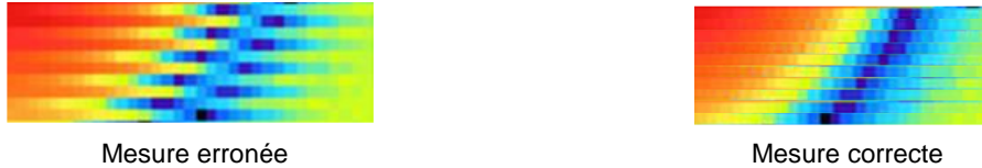
Figure I.11 – Effet de la vibration de la sonde sur une mesure en champ proche.
