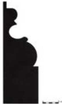
a – base à scotie surcreusée et griffes tribune occidentale. support fort A' 2 Cliché et dessin Br. Danel-Marcé
