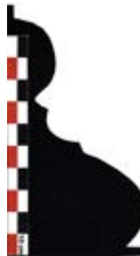
a – base à tore inférieur en bec-de-corbin tribune occidentale. support engagé Cliché et dessin Br. Danel-Marcé
