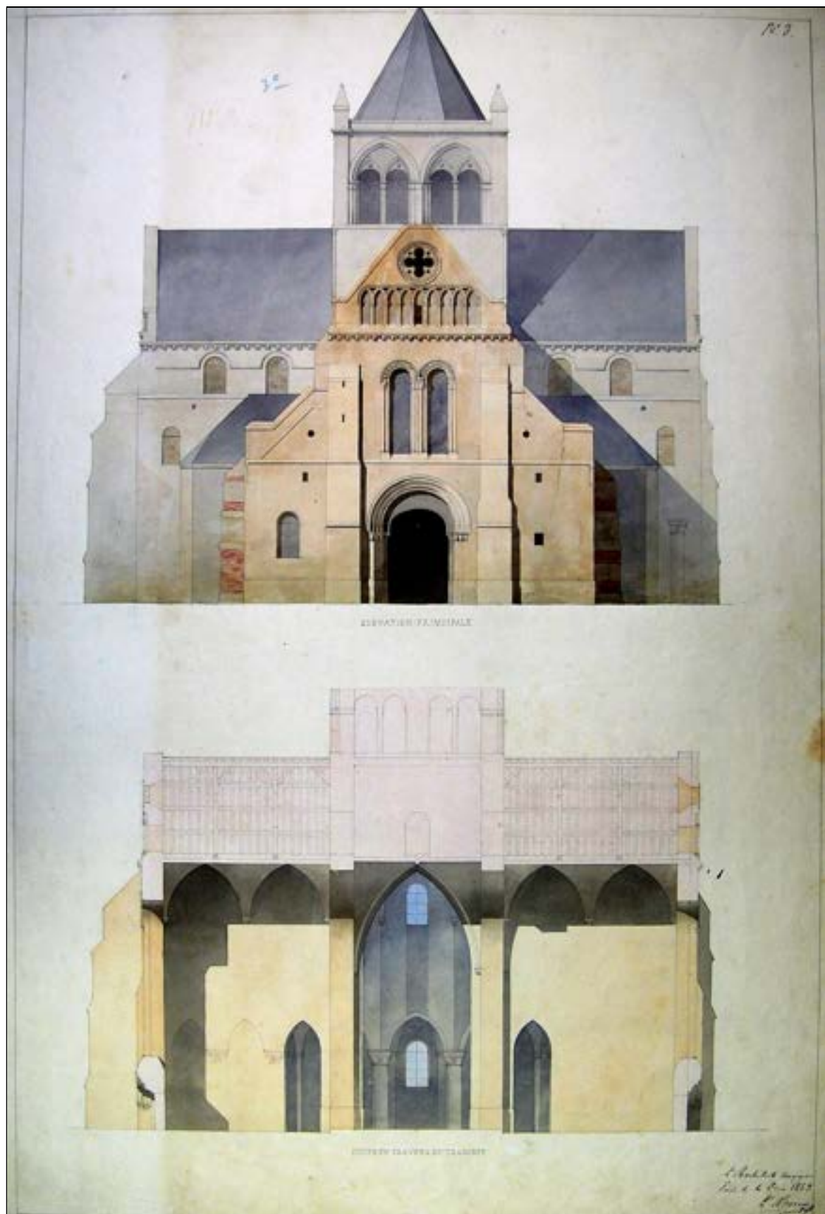
Fig. 59 – Dessin de l'architecte Morey (1843). Pl. n°3 Élévation principale - Coupe en travers du transept (AD-62. 6 Fi C 854) Encre et rehauts de couleur sur papier format 75x106 cm
