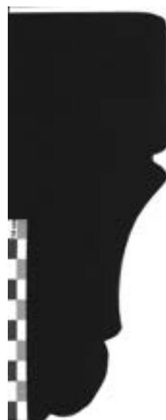
Profil (relevé direct au conformateur)
