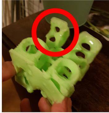
FIGURE 5.4 – Échec de moulage en silicone, pour cause de bulles d'air emprisonnées lors du remplissage.
