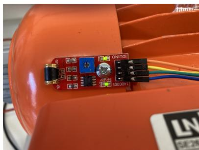
FIGURE 3.3 – Mode opératoire pour l'acquisition des vibrations de la MADA
