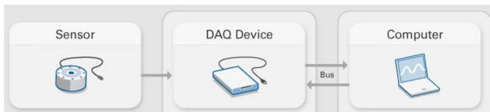
FIGURE 2.9 – Système d’acquisition
