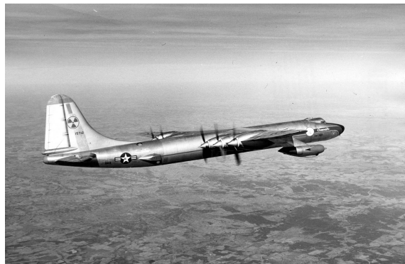
FIGURE 2.3 – NB-36H en vol. Un marquage sur la queue de l'appareil indique la présence du réacteur nucléaire à bord. (photo U.S. Air Force)
