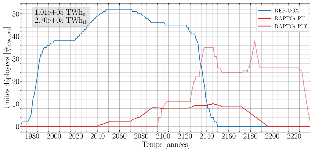
FIGURE 7.5 – Évolution de la composition du parc électronucléaire lors de l'intégration de réacteurs incinérateurs PU/PUf dans le parc avec une gestion du combustible en cycle ouvert et une séparation classique de matières pour une énergie totale produite de 1.01E5 TWh e
