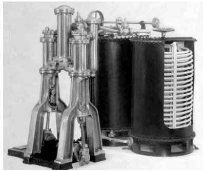
Figure 95 : Machine à froid artificiel de Linde
