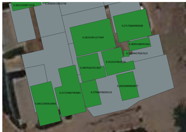
FIGURE 7.22 – Exemple des bâtiments voisins du jeu d'OSM (en vert) ne disposant pas des géométries partagées. Les polygones en gris sont issus de la base de contrôle.
