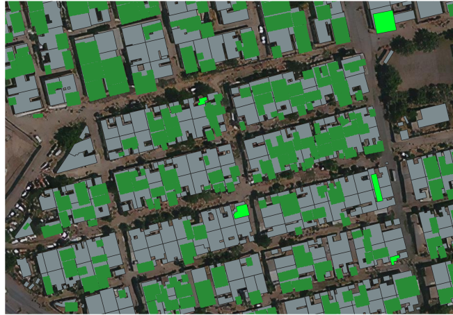
FIGURE 7.23 – Exemple des bâtiments ne respectant pas l’alignement par rapport à la route. Les polygones en gris sont issus de la base de contrôle.
