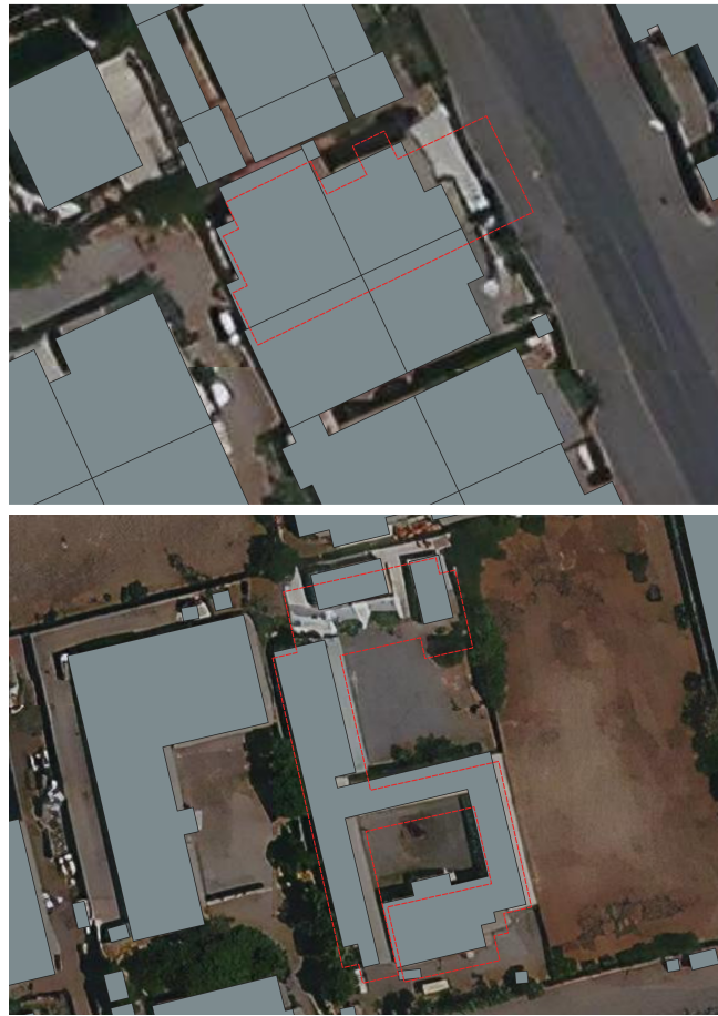
FIGURE 7.21 – Exemple de bâtiment complexe (en rouge pointillé) classé dans la catégorie de mauvaise qualité. Il a été saisi en un seul polygone au lieu de deux polygones. Les polygones en gris sont issus de la base de contrôle.
