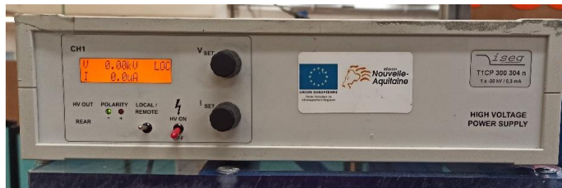
Figure II.16 : Alimentation haute tension de 0 à -30 kV.
