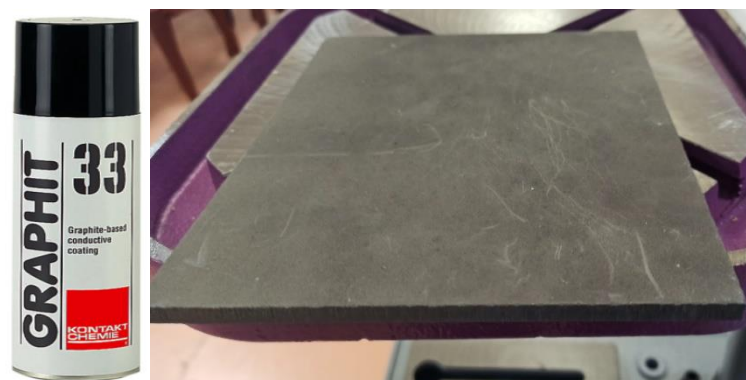
Figure II.12 : Surface inférieure des plaques de PVC peintes avec du graphite.
