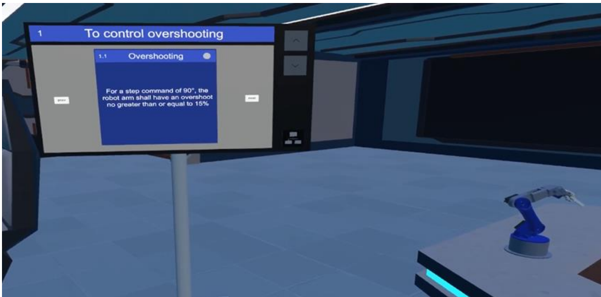
Figure 86 : Vérification "Immersive Model-In-The-Loop" de notre bras de robot
