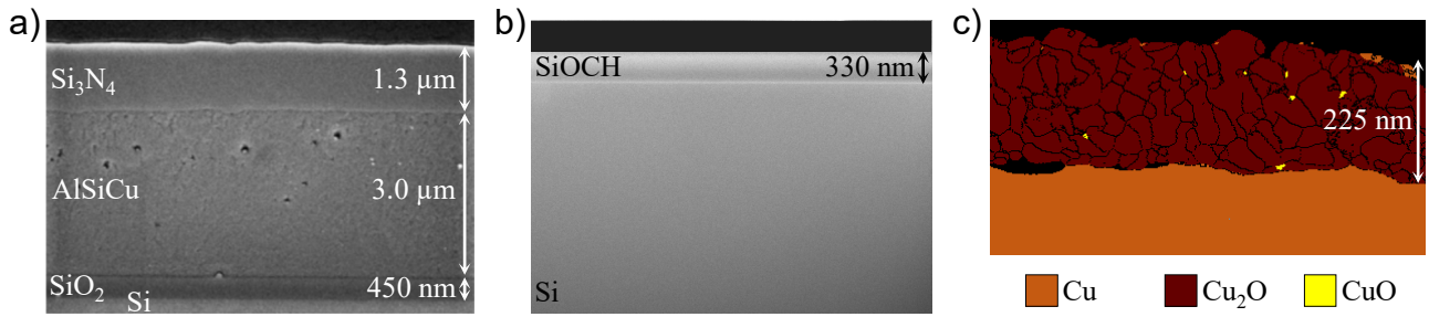
FIGURE I. Images SEM en coupe transversale des systèmes (a) \text{Si}_3\text{N}_4/\text{AlSiCu} , (b) \text{SiOCH}/\text{Si} , et (c) cartographie de phases ACOM/TEM du système \text{Cu}_2\text{O}/\text{Cu} .
