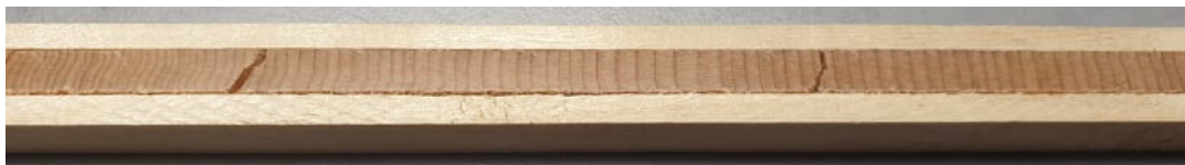
Figure 5.2 – Carotte montée sur un support en bois est polie mécaniquement.
