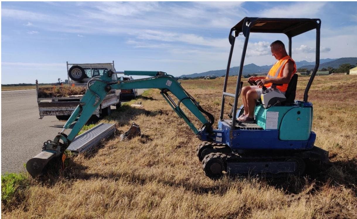
*Figure 52 : Prélèvement d'une motte à la pelleuse*
