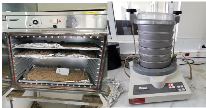
Figure 4 : Séchage des échantillons de sédiments à 30 °C à l'aide d'une étuve (gauche) et tamisage de ces échantillons avec les tamis de mailles de 63 µm, 100 µm, 250 µm, 450 µm, 2 mm (droite).
