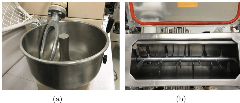
FIGURE 1.17 – Illustration de deux technologies de mélange Low Shear Mixer utilisées dans la fabrication du couscous – (a) Malaxeur à cuve tournante et bras fixe (configuration batch) – (b) Malaxeur à palettes et à cuve en auge (configuration continue).
