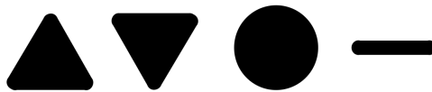
FIGURE 5.21 – Schéma des différents intrus utilisés pour les essais dynamiques. De gauche à droite : (i) forme triangulaire pointe haute, (ii) forme triangulaire pointe basse (iii), forme circulaire, et (iv) forme rectiligne.
