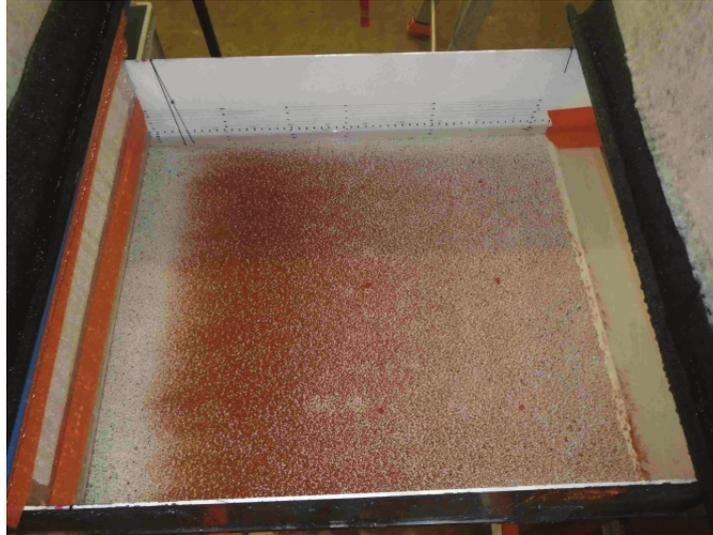
FIGURE 2.8 – Dépôt de sédiments (en rouge) au fond du bac expérimental après 10 minutes d'expérience. Source : thèse de Amina Noughou Bako [NB16]
