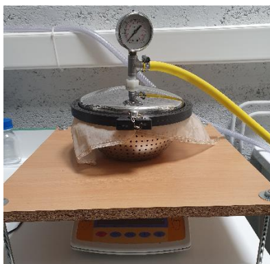
Figure II. 12. Photographie de la mise en place utilisée pour le prétraitement par pressage
