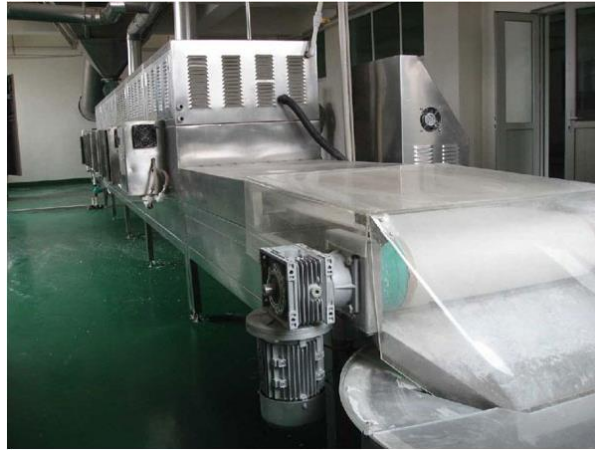
Figure I. 20. Sécheur micro-ondes pour poudres (MAX Industrial Microwave, Yantai, Chine)
