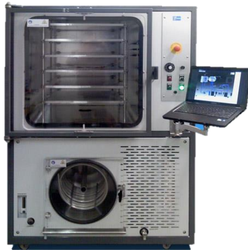
Figure I. 21. Photographie d'un lyophilisateur pilote (Cryotec, Saint-Gély-du-Fesc, France)
