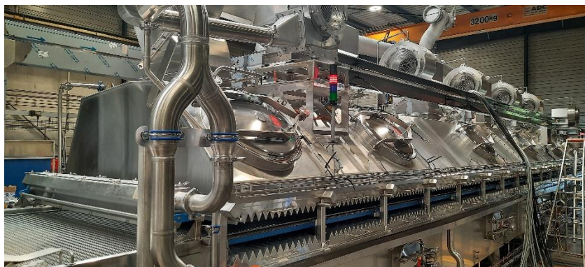
Figure I. 15. Sécheur à jets d'air impactants (CIMS, Sablé-sur-Sarthe, France)
