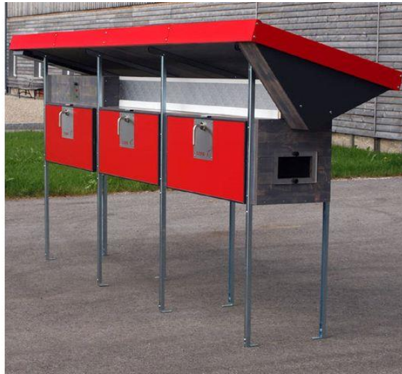
Figure I. 13. Séchoir solaire de type direct (CONA SOLAR, Ried im Traunkreis, Autriche)
