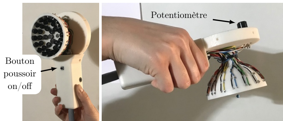
FIGURE 2.2 Emplacement du bouton poussoir (pour la mise en marche et l'arrêt de l'émission acoustique) et du potentiomètre (pour la variation de l'amplitude de l'émission acoustique).
