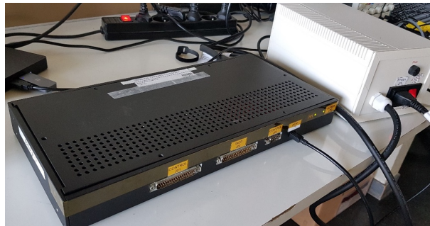
FIGURE 2.5 Boîtier de protection de la carte électronique (en noir à gauche) et son alimentation (en blanc à droite).
