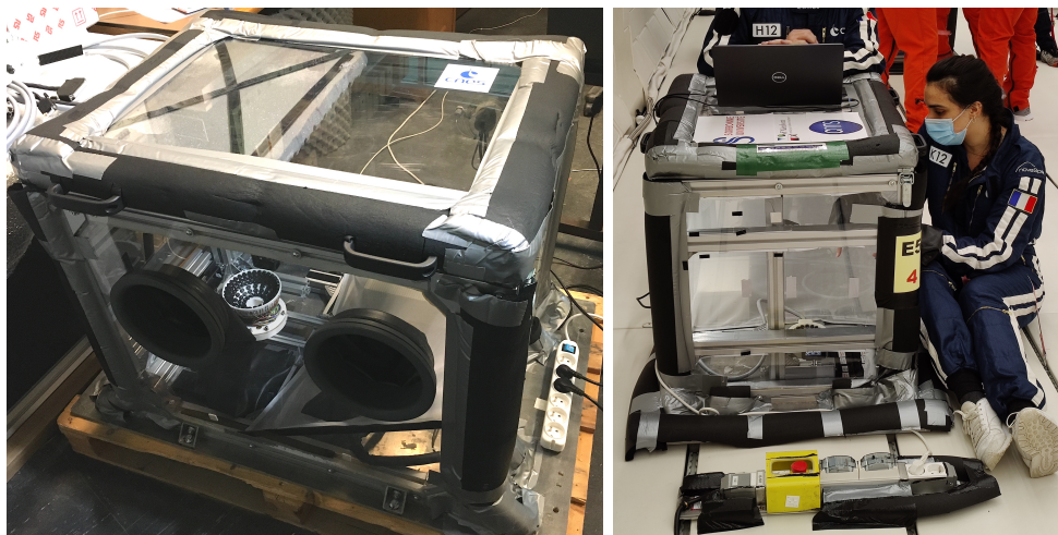
FIGURE 2.32 Rack prêté par le CNES lors des expériences préliminaires de 2020 de la pince acoustique en vols paraboliques - Le rack consiste en un caisson hermétique accessible par des manchons en caoutchouc. La droite du rack est dédiée au boîtier de contrôle de la pince et son alimentation. La gauche est dédiée à la pince acoustique et les billes. Les deux parties sont séparées par un voile ignifugé afin d'éviter la perte des billes. Le plafond du caisson situé au dessus de la pince est recouvert de mousse absorbante. Un ordinateur portable est collé au Velcro sur la paroi extérieure du caisson.
