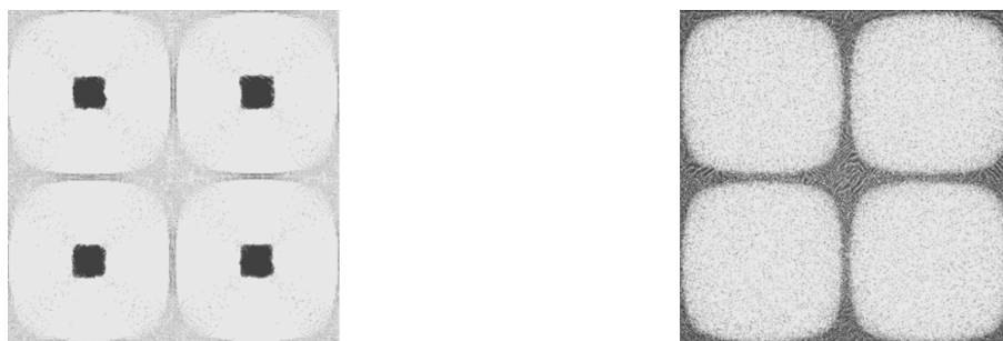
(a) Collections des grains légers aux dessus des ventres de vibration. (b) Collections des grains lourds sur les nœuds de vibration.
