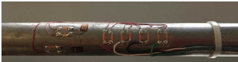
Fig.II. 12 : Fixation du pont de jauges extensiométriques sur barre.
