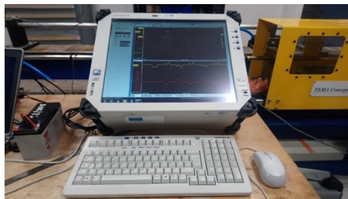
Fig.II. 13 : Baie d'acquisition GENISIS.
