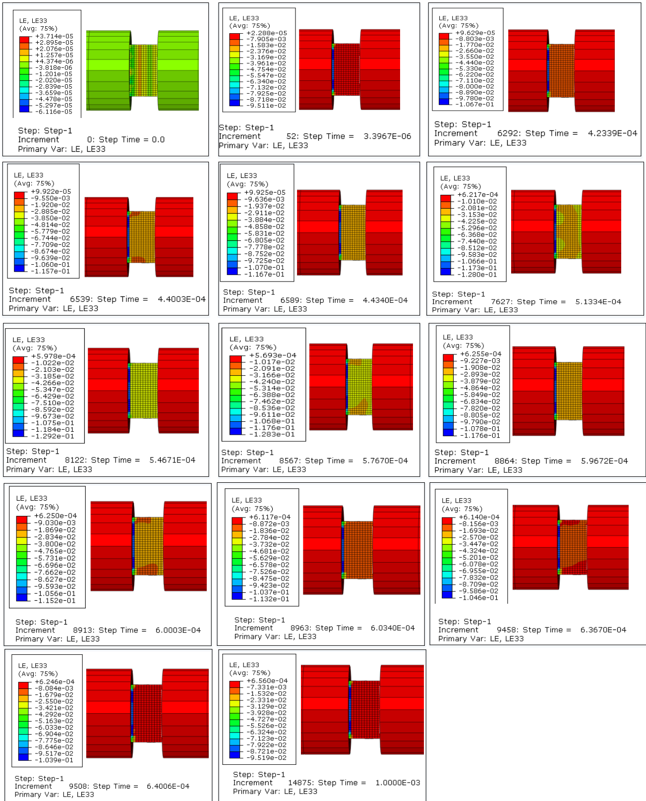
Fig.III. 29 : Compression de l'éprouvette, LE33.
