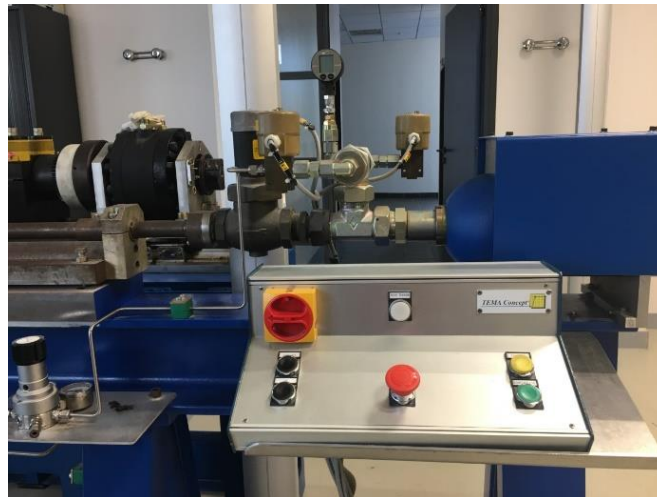
Fig.II. 14: Système hydraulique pour alimenter le dispositif SHPB
