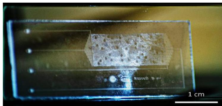
Figure 96 : Photographie du microréacteur en saphir de type poreux hétérogène utilisé pour les expériences d'invasion du CO<sub>2</sub>.
