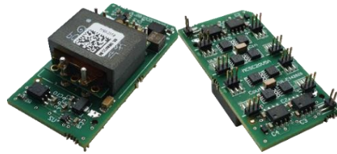
Figure 48 : Le convertisseur DAB DC/DC développé au G2Elab à gauche la face recto, à droite la face verso;
