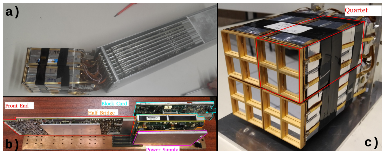
FIGURE 2.2.3 – Photographies des composants d'un bloc de FAZIA. a) Photographie d'une tête de détection en train d'être montée sur son bloc d'électronique. On aperçoit le sarcophage en aluminium entourant les cartes électroniques. b) Photographie d'une carte Front End (en rouge), Block Card (en Cyan), Half Bridge (en orange) et Power Supply (en magenta), reposant sur une plaque de cuivre permettant leur refroidissement. Après montage, ces cartes sont entourées du sarcophage en aluminium présent sur la photo a). c) Photographie d'une tête de détection. En rouge nous mettons en évidence la géométrie d'un quartet.
