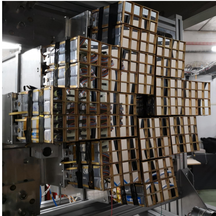
FIGURE 2.2.1 – Photographie des 12 blocs de FAZIA au sein de la chambre à réaction de INDRA.
