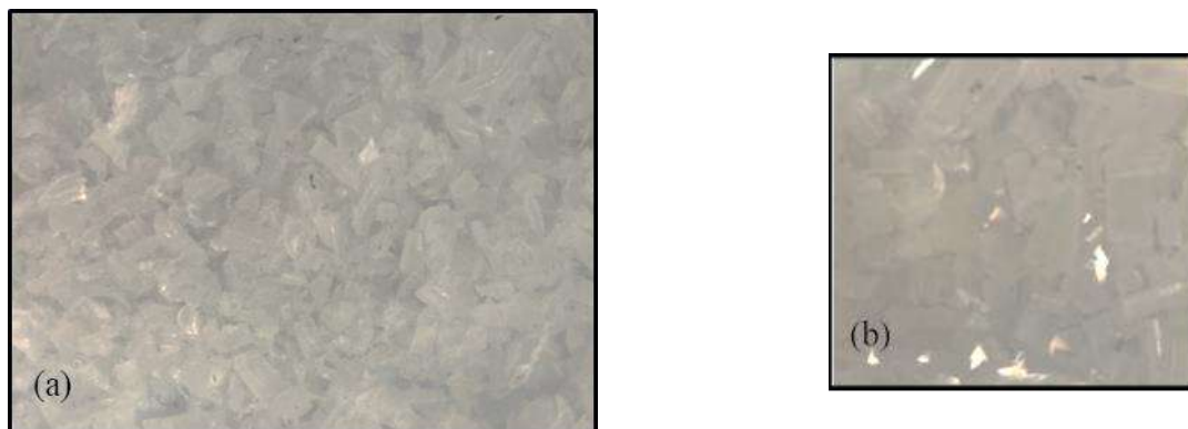
Figure 4-11 : Aspect de broyats issus (a) d'un broyeur et (b) d'un granulateur
