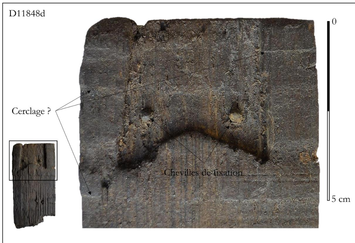
Figure 148: Détail du système de fixation de l'appendice de préhension rapporté sur la douelle D11848d (poignée ou anse) mise au jour à V51 dans le Vestribyggð. En plus d'être fixée à la douelle par au moins deux chevilles/clous en bois, l'appendice de préhension rapporté était peut-être également maintenu en place par un ou plusieurs cerclages dont on distingue les emplacements marqués à la pointe sèche.
