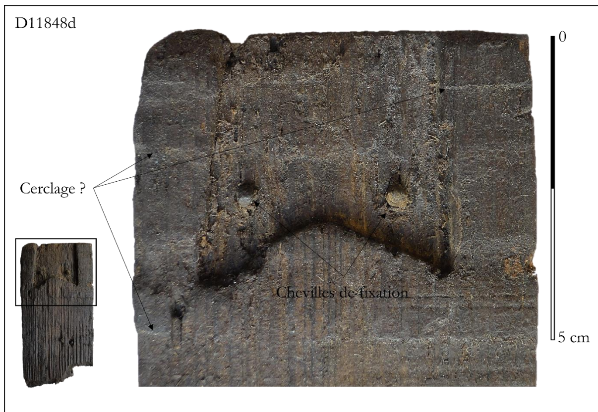
Figure 148: Détail du système de fixation de l'appendice de préhension rapporté sur la douelle D11848d (poignée ou anse) mise au jour à V51 dans le Vestribyggð. En plus d'être fixée à la douelle par au moins deux chevilles/clous en bois, l'appendice de préhension rapporté était peut-être également maintenu en place par un ou plusieurs cerclages dont on distingue les emplacements marqués à la pointe sèche.
