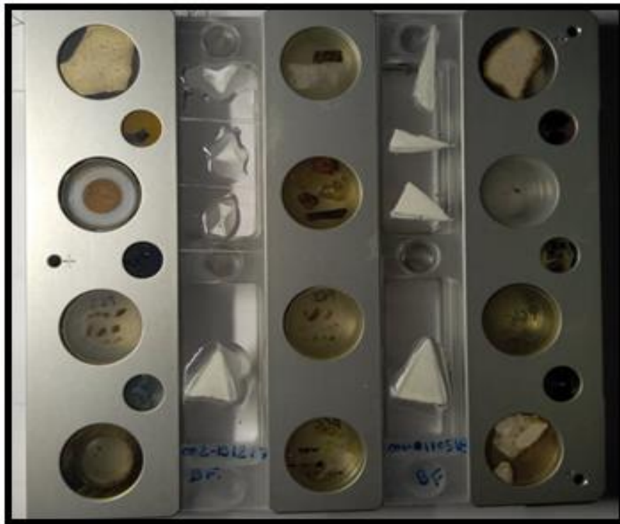
Figure 27 : Echantillons de vertèbres de requin bouledogue placés sur la platine à insérer dans la chambre d'analyse du LA-ICP-MS.
