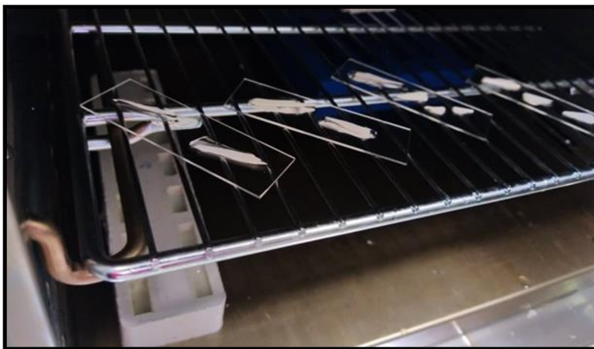
Figure 24 : Différentes lames contenant des vertèbres incluses dans l'Araldite placée dans une étuve à 36°C. Ici plusieurs échantillons sont placés sur une même lame. Uniquement la partie intéressante de la vertèbre pour les analyses microchimiques, le corpus calcareum est monté dans la résine sur les lames
