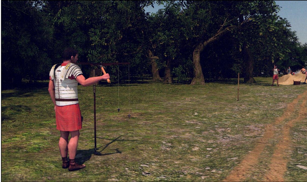
Figure 4. Exemple d'utilisation d'une groma (Botte et al. 2021, p. 35)
