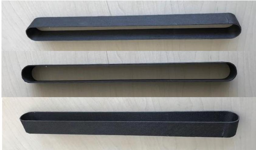
Figure II - 2 : Epreuve composite « loop »
