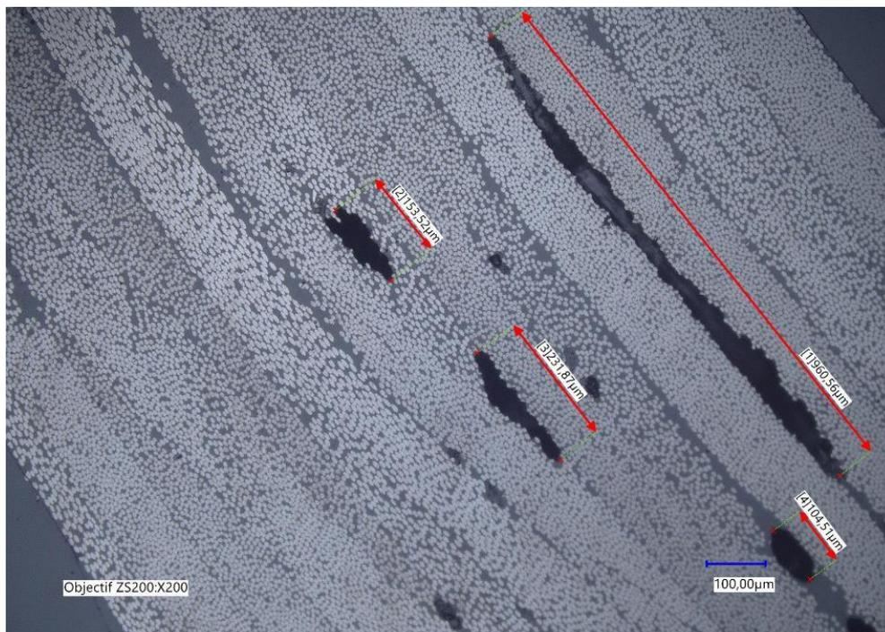
Figure II - 17 : Observations de porosités sur la zone oblongue d'une éprouvette loop
