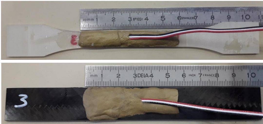
Figure V - 6 : Eprouvettes de résine et de carbone/époxy  $[+/-45]_6$  sur lesquelles ont été placées des jauges de déformation recouvertes de mastic
