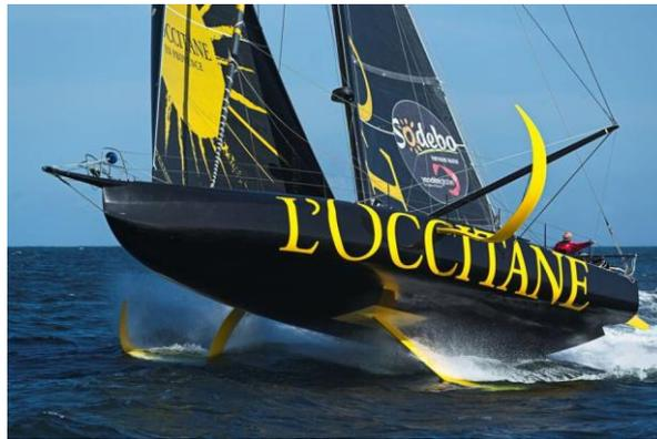
*Figure I - 8 : IMOCA l'Occitane d'Armel Tripon et ses foils en composites (en jaune sous la coque) / ©Pierre Bouras : L'Occitane en Provence*
