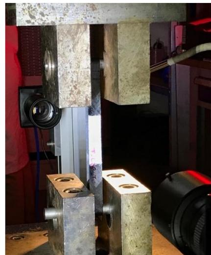
Figure V - 21 : Essais de traction sur éprouvettes loop avec corrélation d'images sur les deux faces
