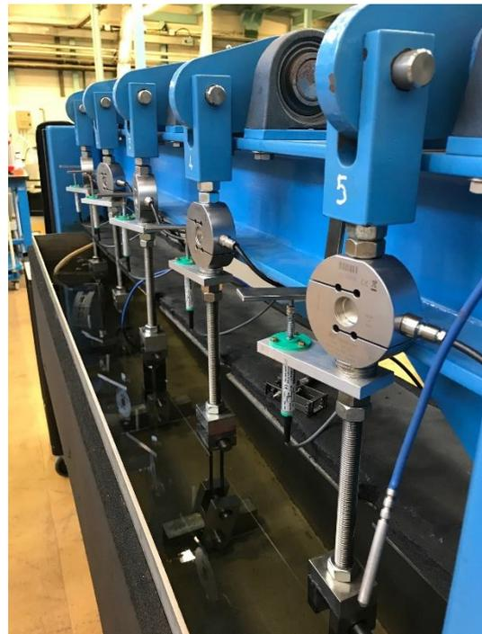
Figure V - 26 : Bancs d'essais utilisés pour l'étude du couplage hygromécanique sur les loops
