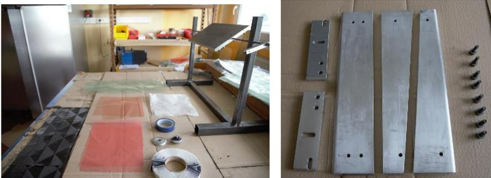
Figure II - 3 : Processus de fabrication (gauche) et moule de drapage désassemblé (droite)
