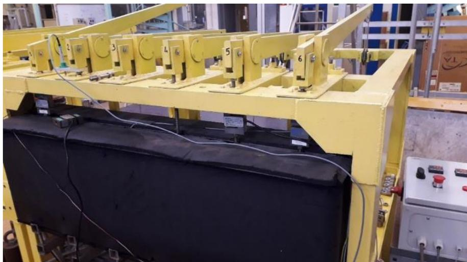
Figure II - 29 : Banc de fluage (BJ6) pour éprouvettes classique en air et en immersion
