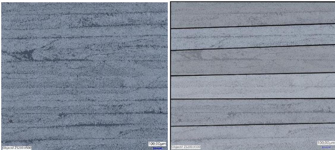
Figure II - 7 : Observation microscopique d'un échantillon de carbone/époxy  $[\pm 45]_6$  (gauche) – architecture du composite doté de 6 doubles plis (droite)
