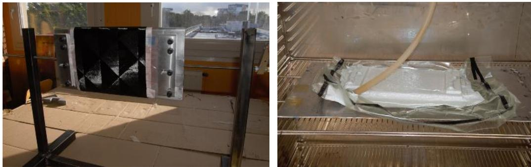
Figure II - 4 : Etape de drapage (gauche) et mise sous vide (droite)
