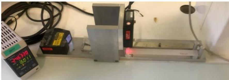
Figure II - 25 : Montage laser pour mesure longitudinale et hors plan, utilisé à IFREMER
