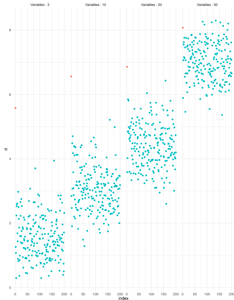
FIGURE 3.5 – Impact de l'estimation de la distance de Mahalanobis d , au centre du modèle en fonction du nombre de variables, pour un ensemble de 200 individus
