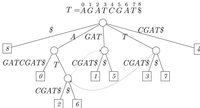
Les structures permettant de représenter un tel arbre sont linéaires en espace et en temps (sous l'hypothèse raisonnable qu'un mot machine peut être stocké et manipulé en  $O(1)$ ).
