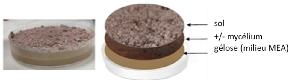
Figure 21. Conception du microcosme en boîte de Petri sans filtres.
