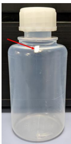
Figure 2.11 : Marquage au ruban adhésif placé sur chaque flacon en Teflon-FEP afin de permettre un bon repositionnement du flacon entre les acquisitions des reference et data scans .
