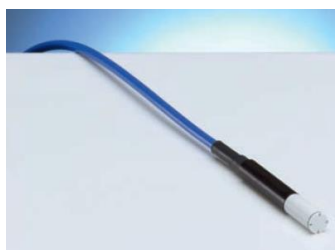
Figure 2.22 : Détecteur microDiamond 60019 de la marque PTW utilisé au laboratoire.
