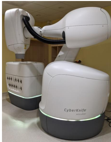
Figure 1.3 : CyberKnife® (accélérateur linéaire miniature sur son bras robotique) et système de changement de collimateurs (Gustave Roussy).
