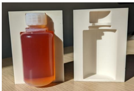
Figure 3.2 : Insert en plastique équivalent-eau spécialement usiné pour la dosimétrie 3D par gel FXG avec le fantôme STEEV.
