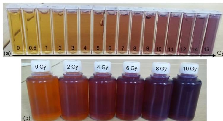
Figure 2.1 : (a) Cuves spectrophotométriques en PMMA et (b) flacons cylindriques en Teflon-FEP remplis de gel FXG et irradiés à des doses absorbées allant jusqu'à 16 Gy.
