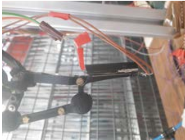
FIGURE 7.22 – Intégration des capteurs d’effort dans la phalange digitale
