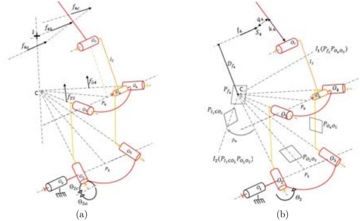
FIGURE 4.3 – (a) Schéma illustrant les contraintes sur stabilité de l'abduction avec une force  $f_4$ .(b) Schéma illustrant les différents éléments qui composent le moment du couple de  $f_4$  sur  $O_2$ .
