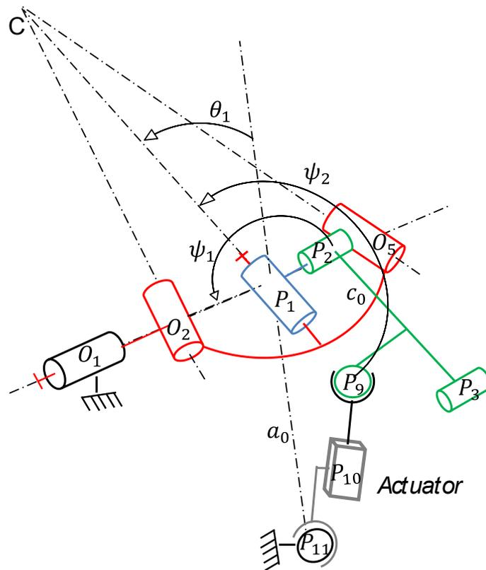
FIGURE 4.8 – Boucle d'actionnement (*Boucle<sub>4</sub>*)
