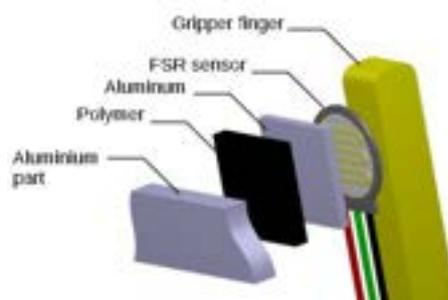
FIGURE 7.16 – Modèle CAO de la surface de contact.
