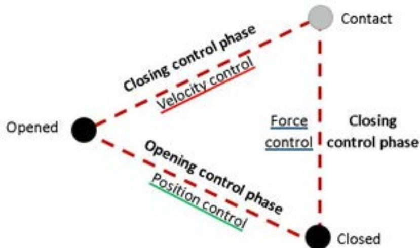
FIGURE 7.10 – Phases de contrôle entre les positions ouverte et fermée.
