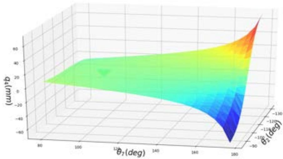
FIGURE 5.10 – Distance  $q_4$  (mm) en fonction du mouvement d'abduction  $\theta_2$  en (degré) et la flexion de la phalange distale  $\theta_7$  en (degré)
