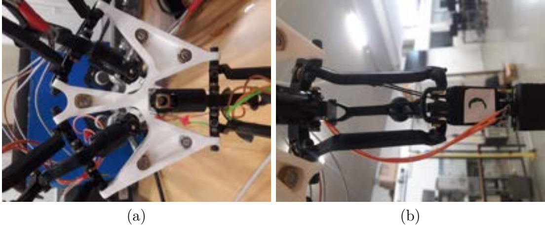
FIGURE 7.2 – (a) : base de la main robotique, (b) : les 4 liaisons concentriques du système sphérique.
