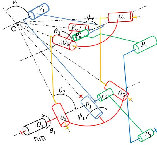
FIGURE 4.4 – Mécanisme virtuel à deux degrés de liberté similaire au mécanisme sphérique.
