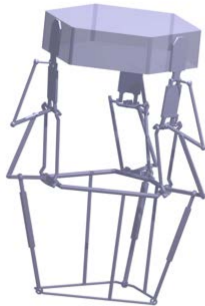
FIGURE 6.4 – Préhension (a) d'un objet de forme parallélépipédique et (b) d'un objet de forme hexagonale extrudée
