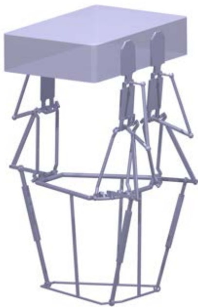
FIGURE 6.4 – Préhension (a) d'un objet de forme parallélépipédique et (b) d'un objet de forme hexagonale extrudée
