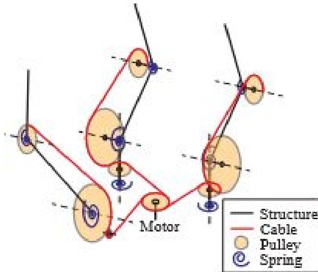
FIGURE 2.10 – Exemple de doigt sous-actionné avec des poulies et des câbles [17]
