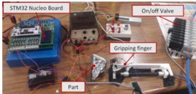
FIGURE 7.14 – Banc d’essai avec un doigt.
