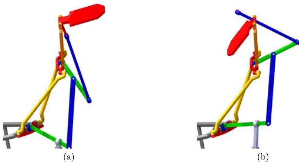
FIGURE 3.3 – Positions singulières de la *boucle*<sub>2</sub> avec l'angle  $\theta_7$  en ouverture (a) ou en fermeture (b). Ces positions sont légèrement influencées par l'abduction et le mouvement de flexion  $\theta_6$ , mais sont, avec les dimensions représentées, éloignées de la frontière de l'espace de travail pour réaliser une préhension.
