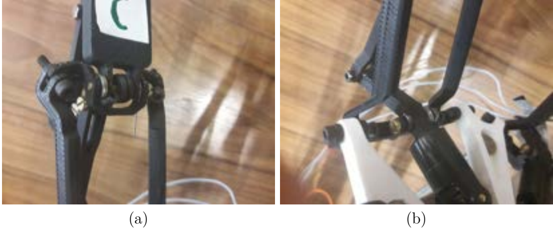
FIGURE 7.4 – (a) : Liaison PIP et (b) : Liaison MCP.
