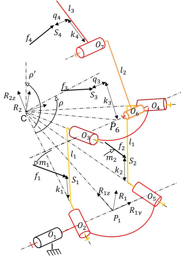
FIGURE 4.2 – Schéma des forces extérieures sur le doigt.
