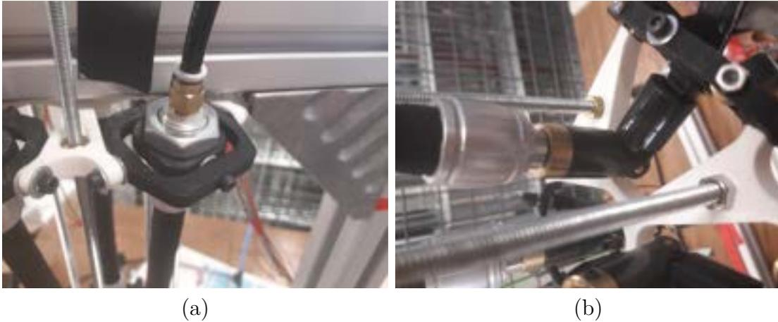
FIGURE 7.3 – (a) : Fixation du muscle pneumatique en liaison rotule sur la base de la main, (b) : Fixation du muscle pneumatique en liaison cardan sur le doigt.
