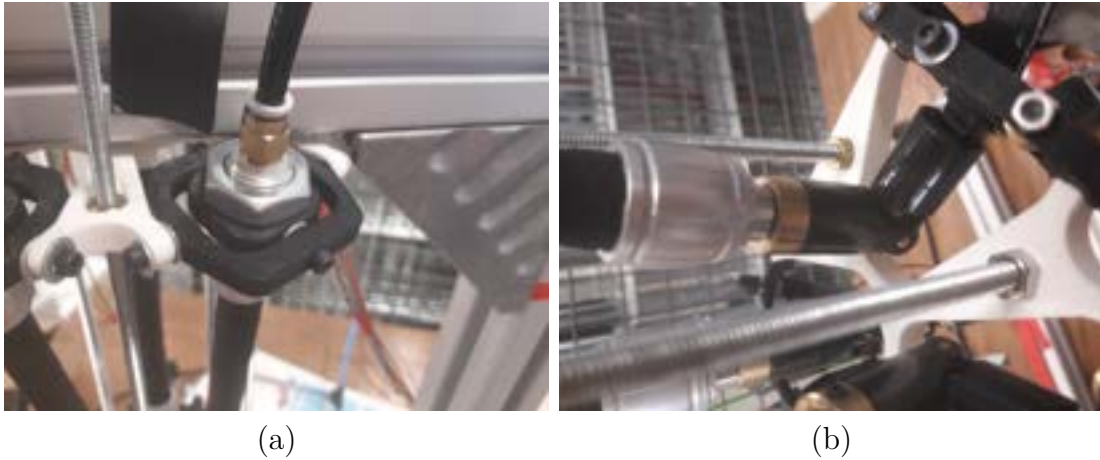
FIGURE 7.3 – (a) : Fixation du muscle pneumatique en liaison rotule sur la base de la main, (b) : Fixation du muscle pneumatique en liaison cardan sur le doigt.
