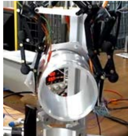
FIGURE 7.24 – Scénario 2 : Résultats expérimentaux de la préhension prismatique avec une référence de force=15 N.
