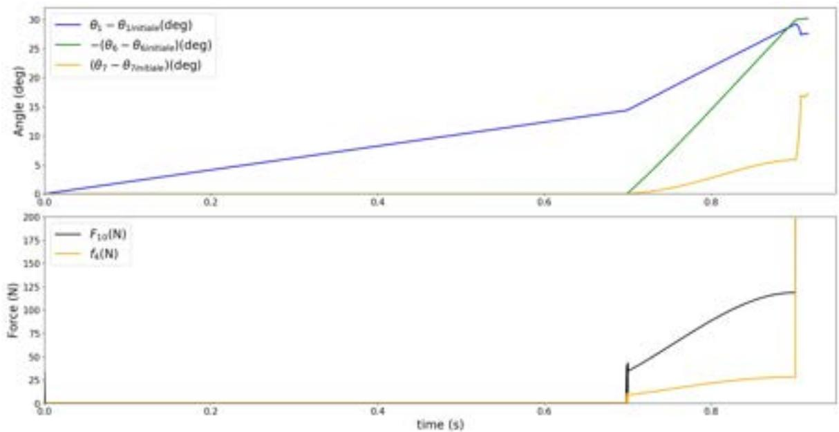
FIGURE 5.16 – Résultats de la simulation dynamique avec le logiciel ADAMS sans la mobilité  $\theta_2$  : **Haut** Angles (deg) en fonction du temps (sec). **Bas** Force  $F_{10}$   $f_4$  (N) en fonction du temps (sec).
