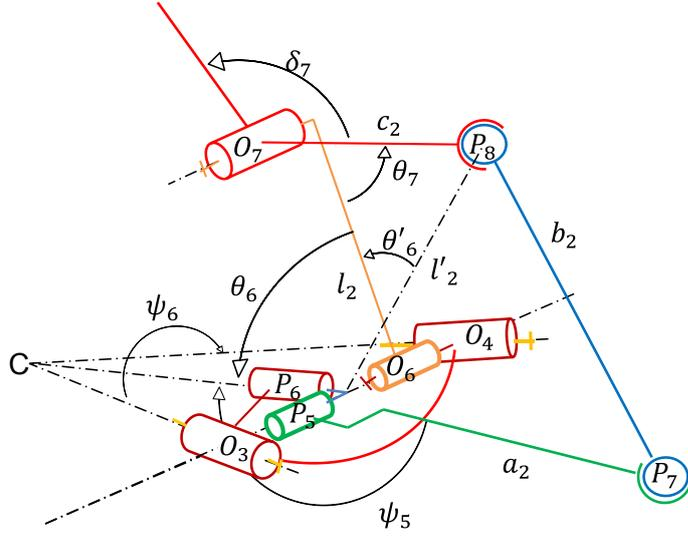
FIGURE 4.5 – Mécanisme *RSSR*
