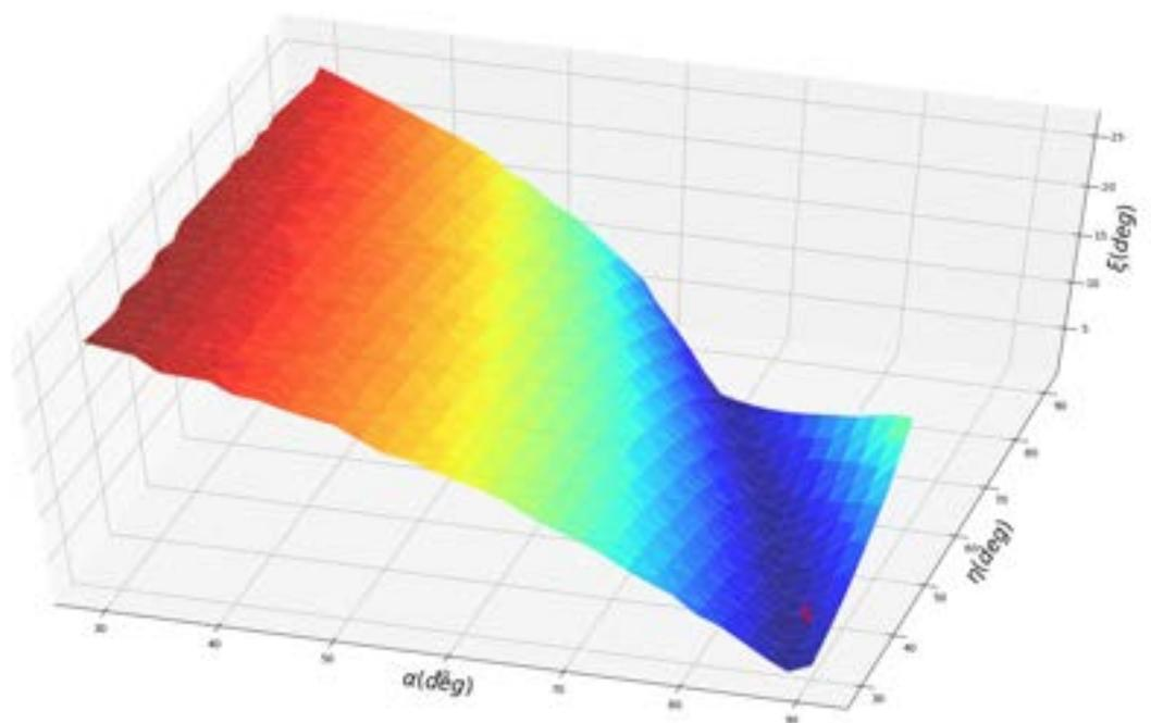
FIGURE 3.9 – l'angle  $\xi$  maximal obtenue pour un mouvement de  $\delta \pm 30^\circ$  avec en abscisses  $\alpha$  and  $\eta$  la solution retenue est représenté par le point  $S$
