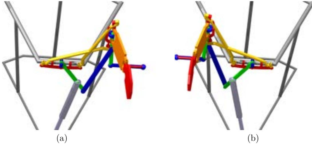
FIGURE 3.2 – Positions singulières du mécanisme sphérique de la phalange proximale avec  $\theta_2 = 0$  (a) et  $\theta_2 = \pi$  (b). Dans ces configurations, les éléments du système sphérique sont dans un même plan.
