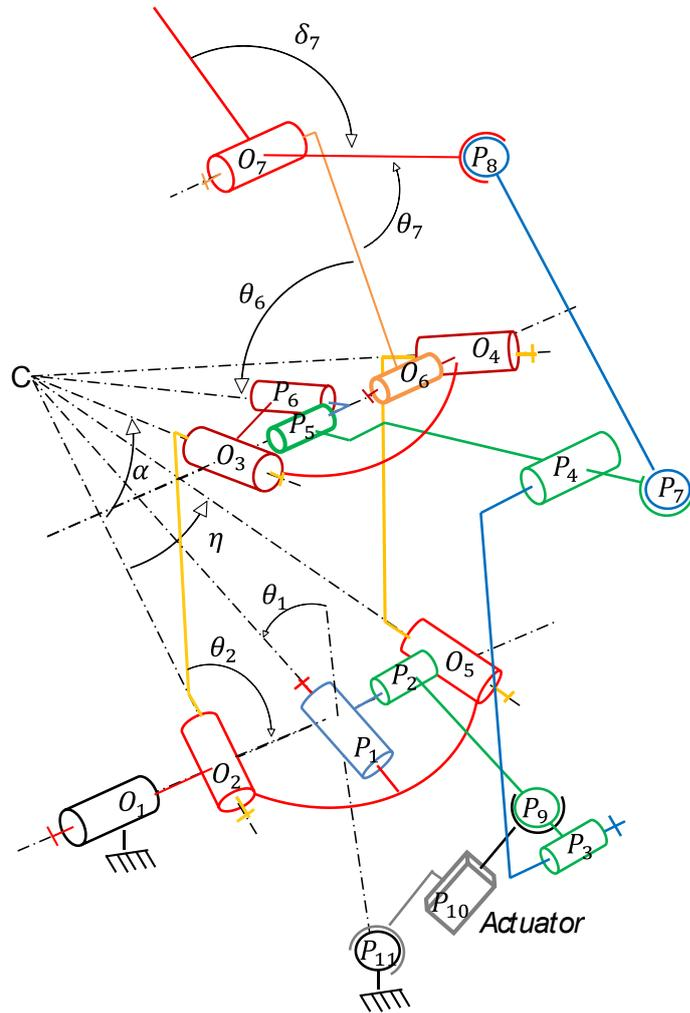
FIGURE 3.1 – Cinématique de la nouvelle architecture des doigts
