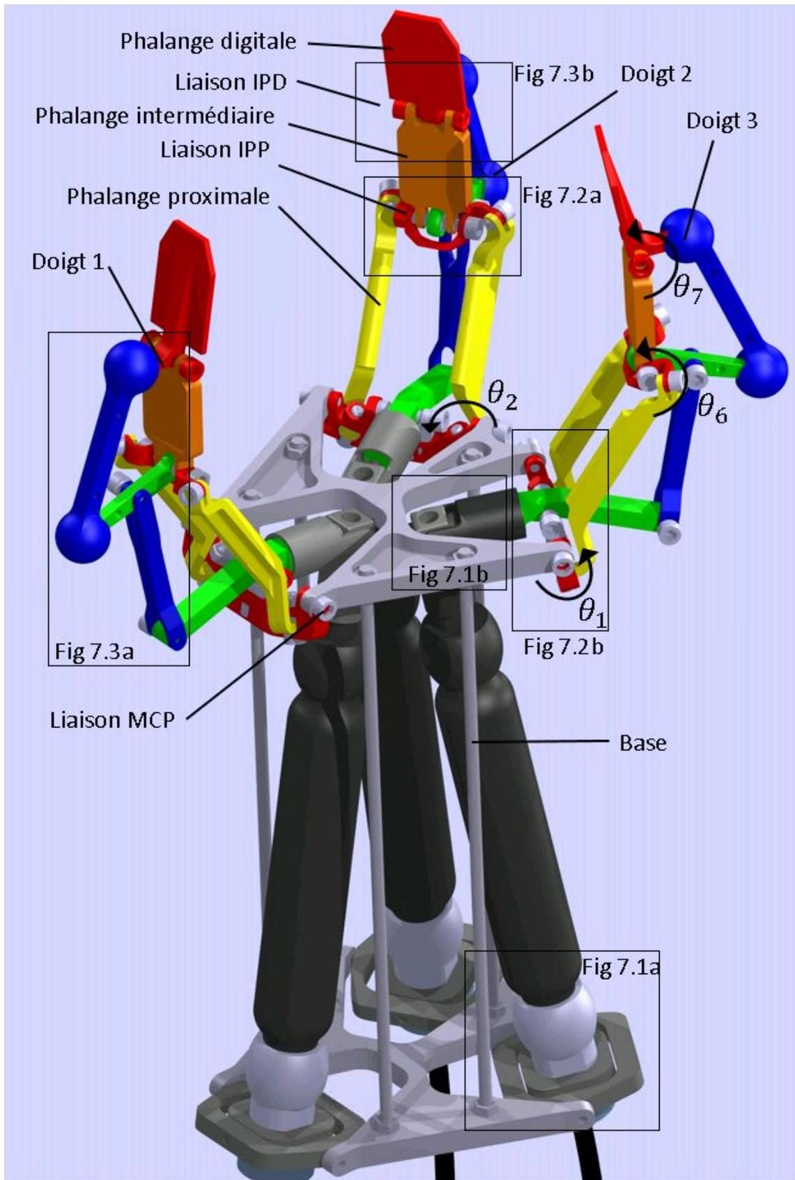
FIGURE 7.1 – CAD du prototype et désignation des sous-ensembles
