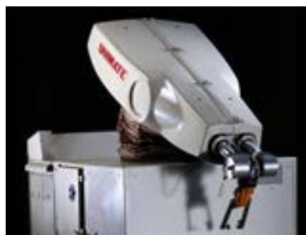
FIGURE 1.1 – Ultimate Robot : premier robot industriel avec une pince comme effecteur pour la préhension d'objet.
