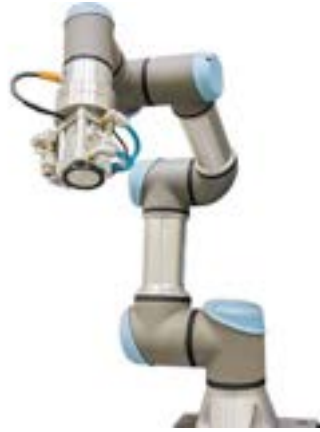
FIGURE 2.2 – Exemple d’application de l’effet électromagnétique pour la préhension d’objet avec un robot.
