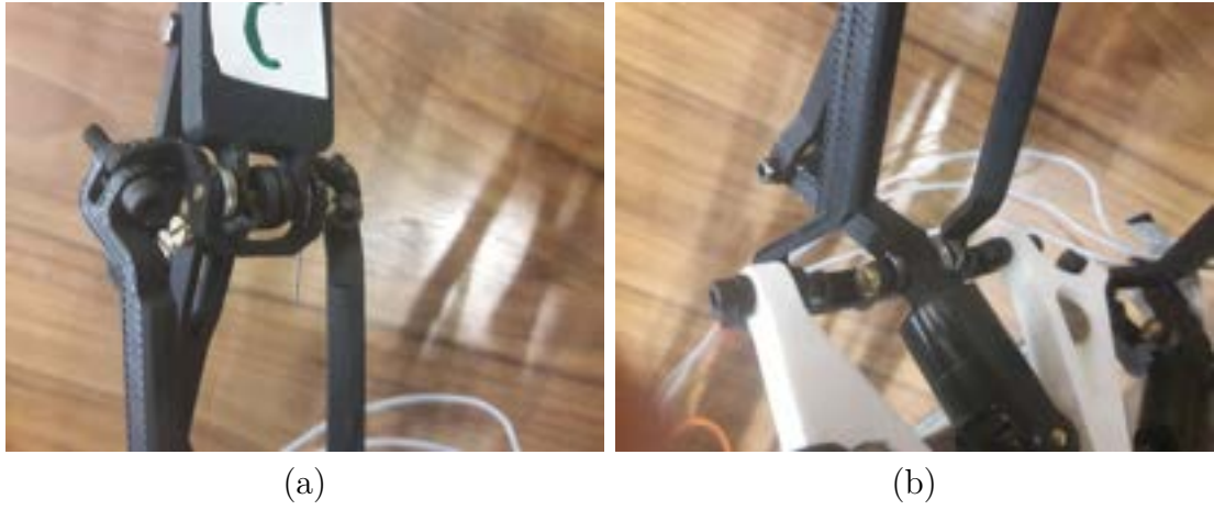
FIGURE 7.4 – (a) : Liaison PIP et (b) : Liaison MCP.
