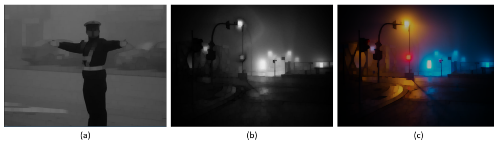
FIGURE 3.12 – Le voile atmosphérique avant l'étape de raffinement : (a) estimation du voile atmosphérique d'une image de brouillard blanc, (b) estimation du voile atmosphérique d'une image brumeuse colorée à partir du canal couleur avec l'intensité minimale, (c) estimation du voile atmosphérique d'une image brumeuse colorée de chaque canal de couleur (adapté avec la permission de Broyer (2017). Copyright 2021 Mark Broyer).
