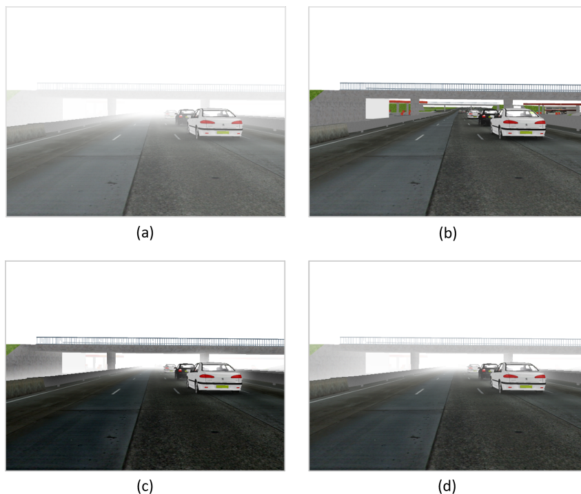
FIGURE 3.1 – Résultats de l'algorithme DCP avec différentes valeurs de \omega sur une image de la base FRIDA : a) image avec brouillard, b) vérité terrain, c) image restaurée avec \omega = 0.95 , d) image restaurée avec \omega = 0.75
