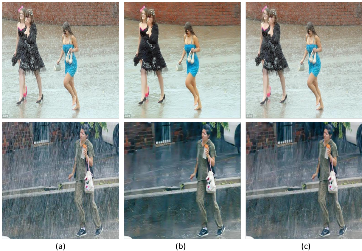
FIGURE 5.8 – Résultats de l'atténuation des traînées de pluie sur des images du monde réel : (a) image en entrée, (b) image restaurée DA-UNet, (c) image restaurée avec la méthode de Zhang and Patel (2018) .
