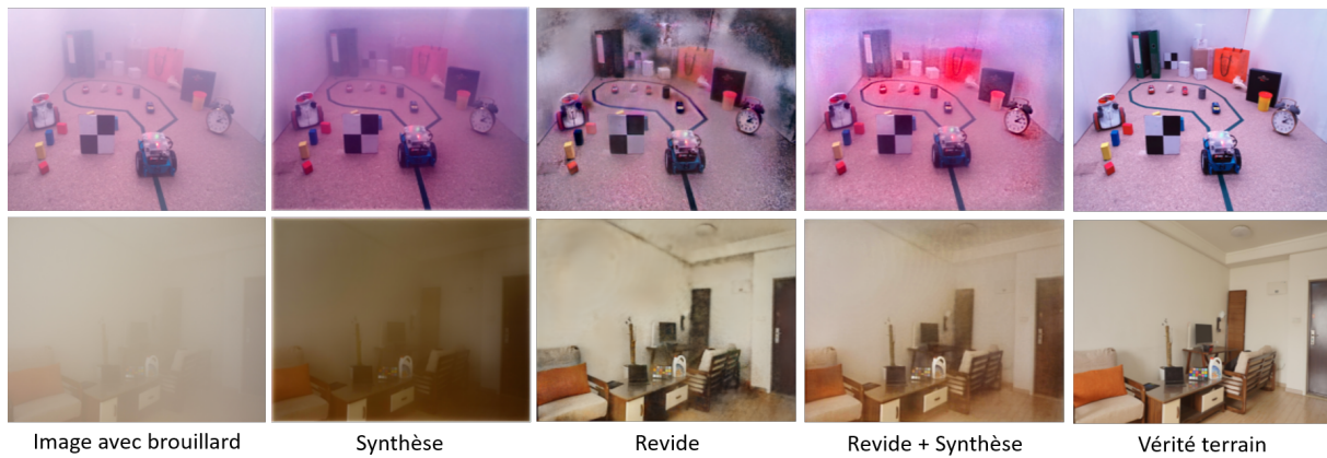
FIGURE 4.32 – Résultats obtenus sur les images des bases de données REVIDE et VIREDA à partir du réseau appris avec différentes bases d’apprentissages.
