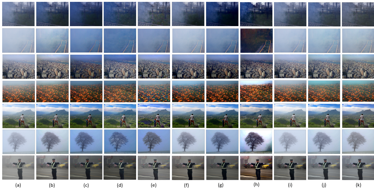
FIGURE 3.19 – Comparaison des résultats après restauration des images contenant du brouillard sur des images réelles : (a) images d'entrée, (b) DCP , He et al. (2011), (c) NBPC , Tarel (2009), (d) Zhu et al. (2018), (e) Zhu et al. (2021), (f) Dehaze-Net , Cai et al. (2016) (g) AOD-Net , Li et al. (2017), (h) GCA-Net , Chen et al. (2019), (i) FFA-Net , Qin et al. (2019), (j) MFP-W , et (k) MFP-C .
