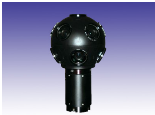
FIGURE 1.6 – Système multicaméra Dodeca 2 360 (Immersive Media)
