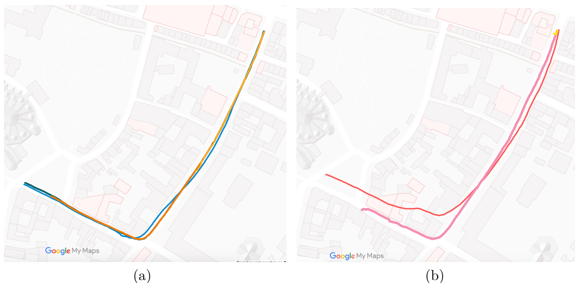
FIGURE 3.3 – Suivi direct basé sur un modèle 3D avec SoMGP et SoP avec la caméra à bord d'un véhicule. Trajectoires estimées pour (a) la première séquence S1 (GPS : bleu ; poses de la caméra issue du processus de photogrammétrie : vert foncé ; SoMGP : orange ; SoP : jaune) et (b) la deuxième séquence S2 (GPS : rouge ; SoMGP : rose ; SoP : jaune). Les trajectoires sont tracées après conversion en coordonnées de latitude et de longitude exportées sous forme de fichiers kml vers Google My Maps (carte de base monochrome).
