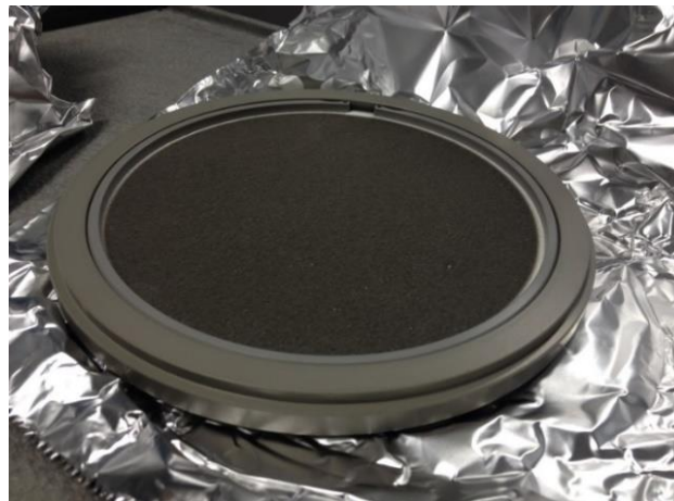
Figure 23 : Filtre PM 10 après 3 jours de prélèvement d'air à un débit de 500 L/min avec le Digitel DH-77 (ici prélèvement Hiv9).
