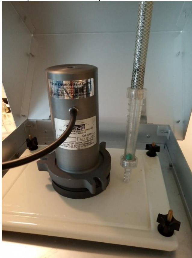
Annexe 1 : Comparaison débit affiché par TISCH VFC+ et débitmètre à bille
