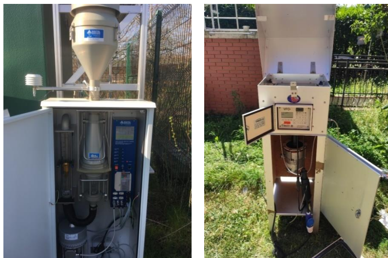
Figure 19 : Systèmes de prélèvements utilisés : le Digital DH-77 pour la collecte des PM 2,5 et PM 10 (à gauche) et le TISCH VFC+ pour la collecte des TSP (à droite).
