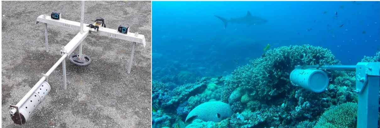
Figure 15 : Dispositif BRUVS et image obtenue sur caméras lors d'un déploiement sur le récif corallien. © IRD/Florian Baletaud.
