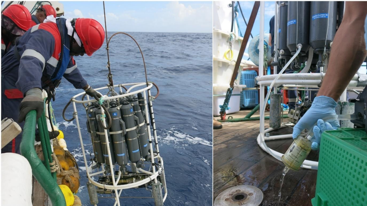
Figure 29: Déploiement des bouteilles Niskin pour prélever le volume d'eau nécessaire à profondeur souhaitée (gauche). Filtration sur le pont de l'ALIS (droite) de l'eau prélevée dans les bouteilles Niskin à l'aide d'un tuyau stérile connecté aux bouteilles, à une pompe péristaltique et à la Capsule de filtration VigiDNA® avec son filtre en ailette en polytérosulfone à 0.2µm. © Laurent Vigliola
