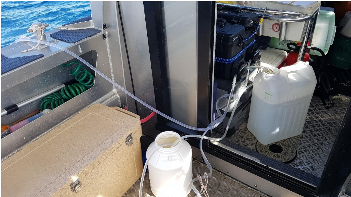
Figure 27: Filtration en cours avec le tuyau sortant du bateau. L'eau sortie du filtre est jaugée dans un bidon de 32L pour déterminer la fin de la filtration. Le deuxième tuyau raccordé à la 2 ème pompe péristaltique a bord tourne en circuit fermé dans le contenant blanc remplie de javel.
