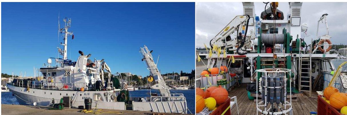
Figure 24: Navire océanographique ALIS de la flotte océanographique française. Long de 29 mètres, ce navire permet de naviguer jour et nuit en continu pendant une vingtaine de jour en autonomie. L'espace sur le pont permet d'embarquer un volume important d'équipement à son bord, permettant entre autres de déployer des caméras en eau profonde, prélever de l'eau à l'aide de la rosette de bouteilles Niskin/sonde CTD ou encore de poser des palangres de pêche. © Florian Baletaud.
