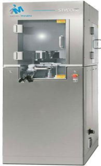
Figure 7: Presse instrumentée pour la compression uniaxiale (Styl'One) pouvant simuler différentes presses industrielles
