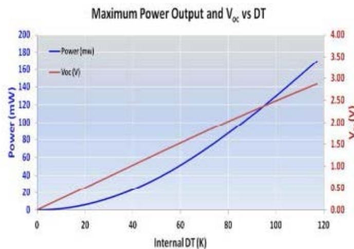
Figure 144. Données constructeur des propriétés thermoélectriques du module HV-56
