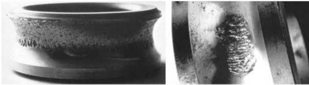
Figure 54. Dégradations du chemin de roulement dues à des surcharges mécaniques (extrait de [14])
