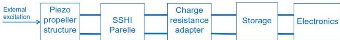
Figure 288. Schéma bloc récupérateur piézoélectrique en hélice
