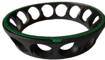
Figure 189. Circuit secondaire sur la cage
