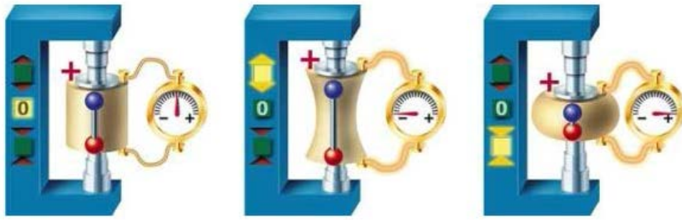
Figure 117. Effet piézoélectrique direct
