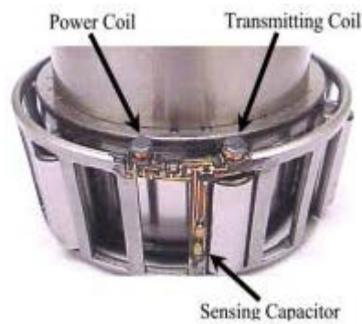
Figure 73. Vue en coupe du capteur de température et de la transmission sans fil (extrait de [66])
