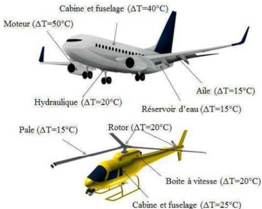
Figure 107. Représentation schématique des gradients thermique dans les structures de type avion et hélicoptère
