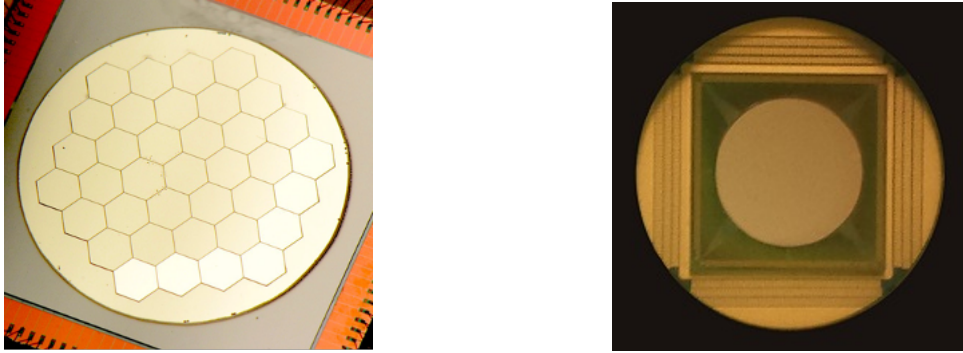
FIGURE 2.2 – Différents types de miroirs déformables. De gauche à droite : un miroir segmenté (source : http://www.irisao.com ), un miroir à surface continue (source : bostonmicromachines.com )
