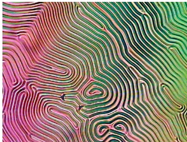
FIGURE I.16 – Image de la texture en empreintes digitales d’un CLC dont le pas p est de l’ordre du micromètre [56].
