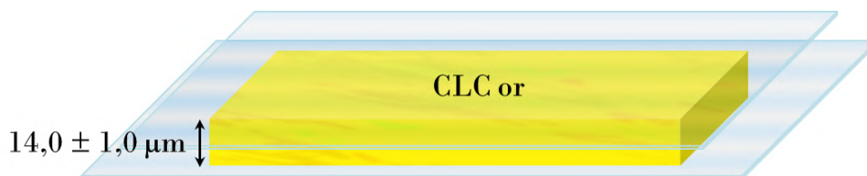
FIGURE VI.4 – Film CLC or d'épaisseur contrôlée formé à 80\ ^\circ\text{C} entre deux substrats de verre traités au PVA brossé.
