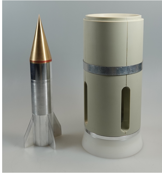
FIGURE 3.14 – Photo du projectile avec une pointe en laiton (remplacé par du tungstène pour ces expériences) et du sabot comprenant la jupe d'étanchéité en (blanc), l'assiette de poussée (en aluminium) et les 4 pétales (en beige)
