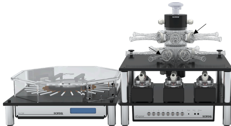
Figure 33 – Machine d'exposition InExpose system (EMKA technologies) permettant une exposition à la fumée de cigarette classique en mode « nose-only ». Les flèches indiquent l'emplacement des souris. Des filets de contention pour souris sont fixés sur une tour avec des orifices individuels permettant la distribution équivalente de la fumée à chaque souris exposée.
